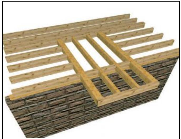
Figure (137) : Porte à faux type 1/Source : PDF/ Construction de maisons à ossature bois « Thierry Paradis », P 122
