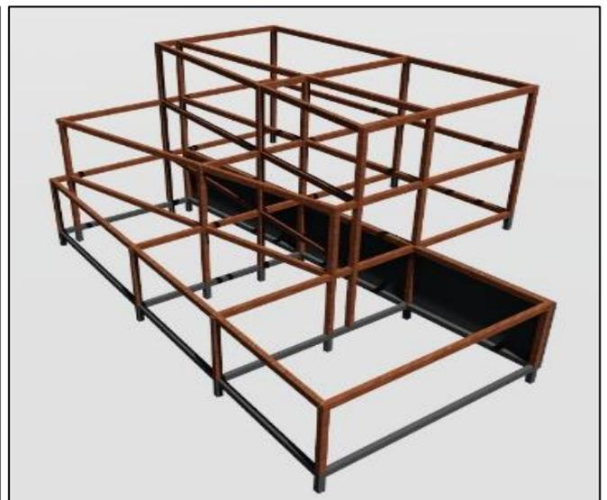
Figure (132) : Ossature de notre projet /Source : Etablie par
