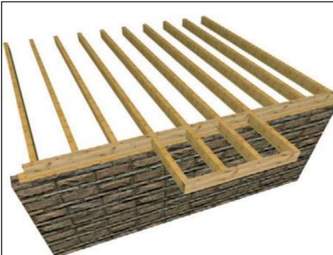
Figure (136) : Porte à faux type 1/Source : PDF/ Construction de maisons à ossature bois « Thierry Paradis », P 122
