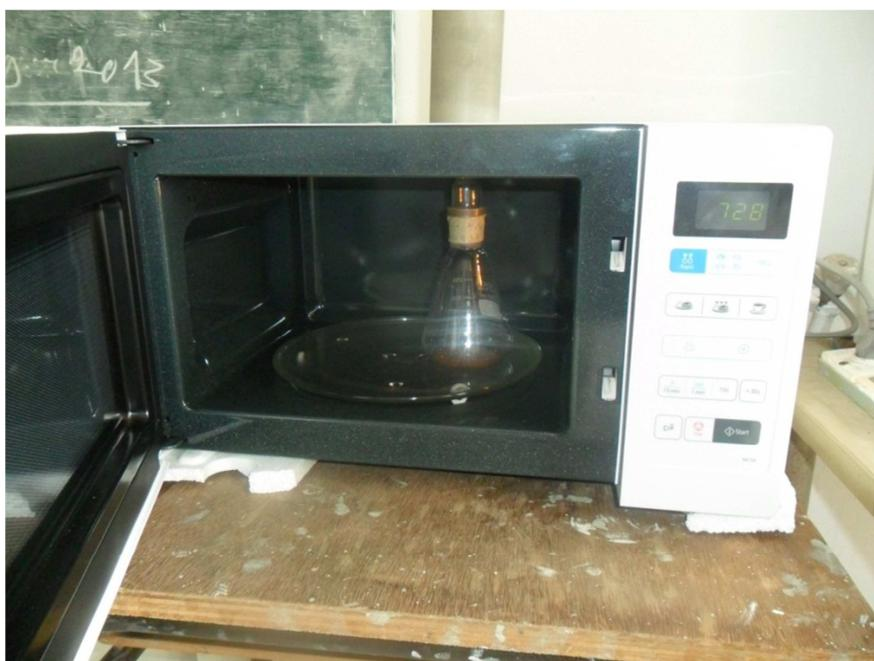
**Figure 4** : Dispositif de réaction sous micro-ondes.
