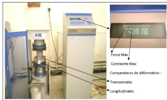
Figure II.8. Presse utilisé pour les cylindres 160 \times 320 mm.
