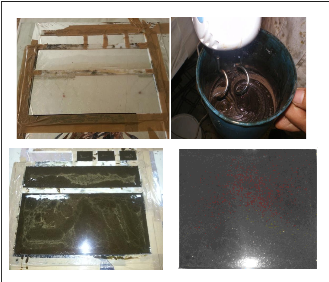
Figure II.5: Principe de confection des différents patchs en liège.
