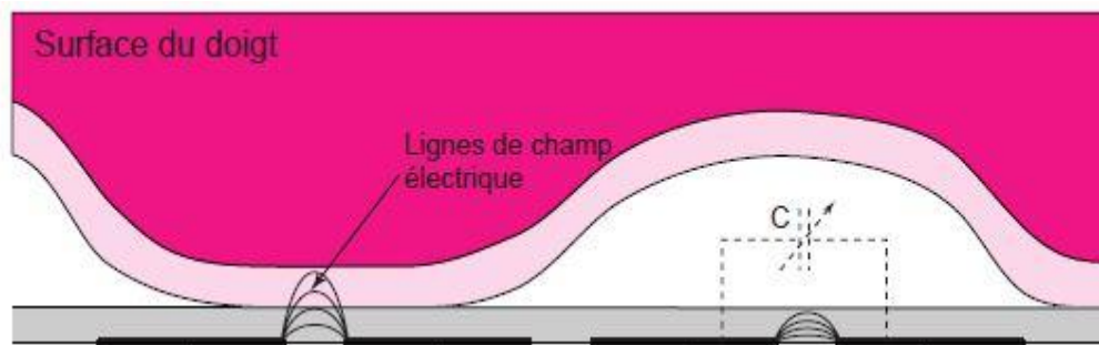
Fig. II.13 : Capteur capacitif utilisant des pixels à double électrode
