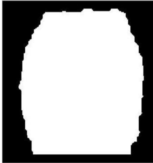
Fig.III.15 : Création d'un masque pour ne travailler que sur la partie intéressante de l'image
