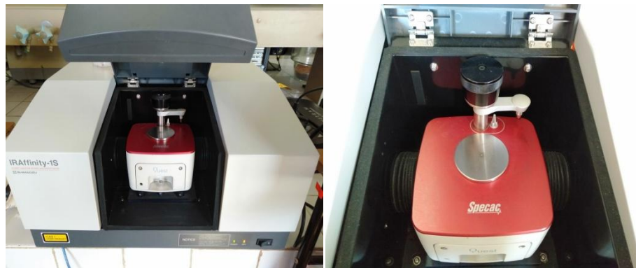
Figure N°32 : « Spectromètre IRTF » muni d'un accessoire ATR à simple réflectance avec Zoom sur le placement des échantillons
