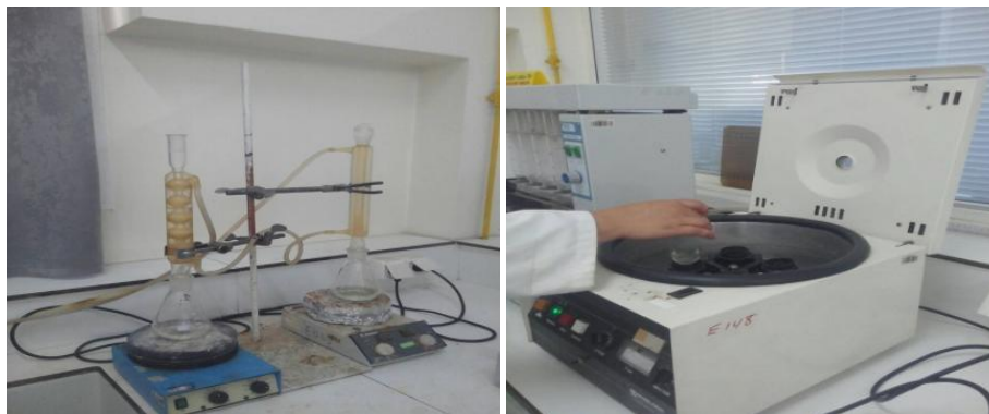
(a) : Montage d'extraction de la cellulose (b) : Centrifugeuse
