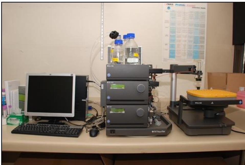
**Figure 13 :** Photographie de l'appareillage de chromatographie liquide rapide des protéines (FPLC) semi-automatisé ÄKTA-Purifier.
