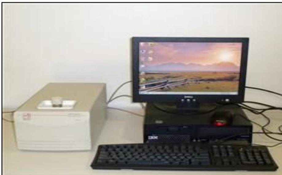
**Figure 16** : Photographie d'un microcalorimètre à balayage de température, modèle Microcal VP-DSC.
