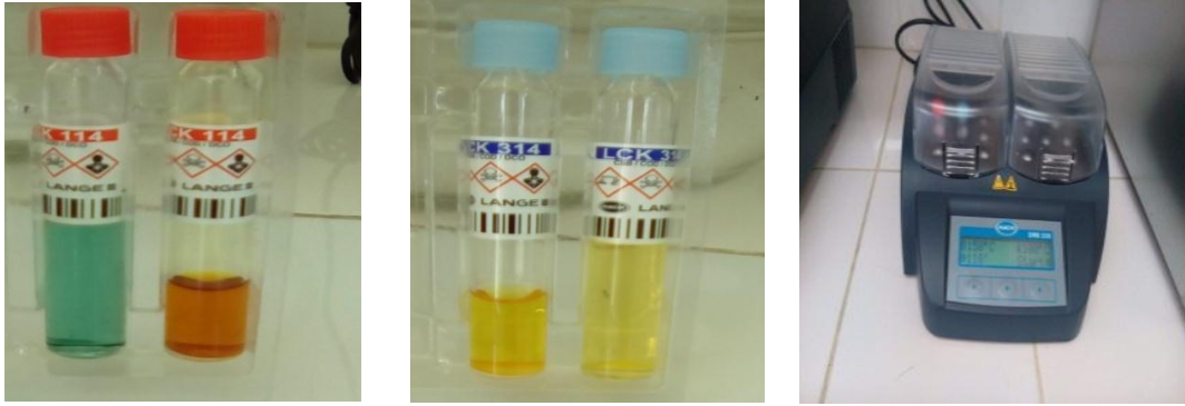
Figure 27 : le matériel utilisé pour la mesure de DCO.
