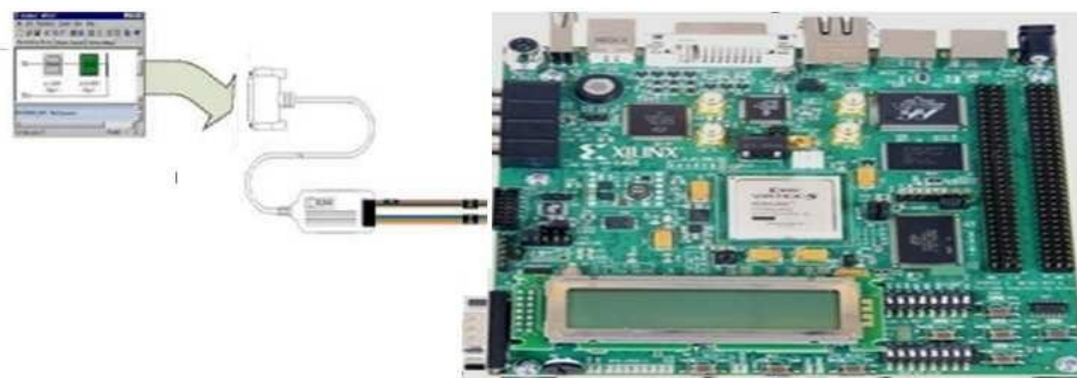
Figure (III.06). Programmation d'un FPGA avec un câble JTAG en utilisant l'application IMPACT.[21]
