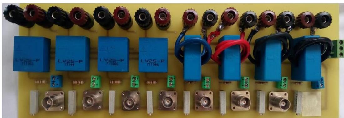
Figure IV. 18. Photographie de la carte de mesure réalisée
