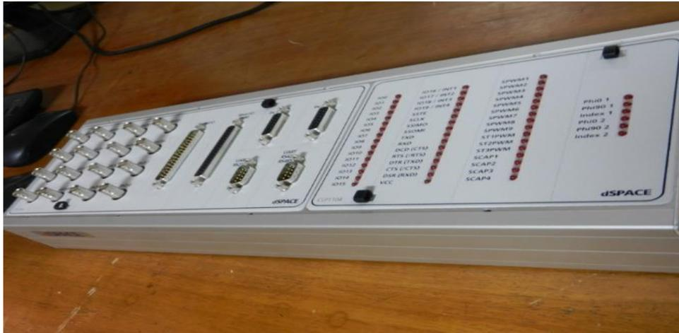
Figure IV. 15. Illustration du Panneau de contrôle CP1104
