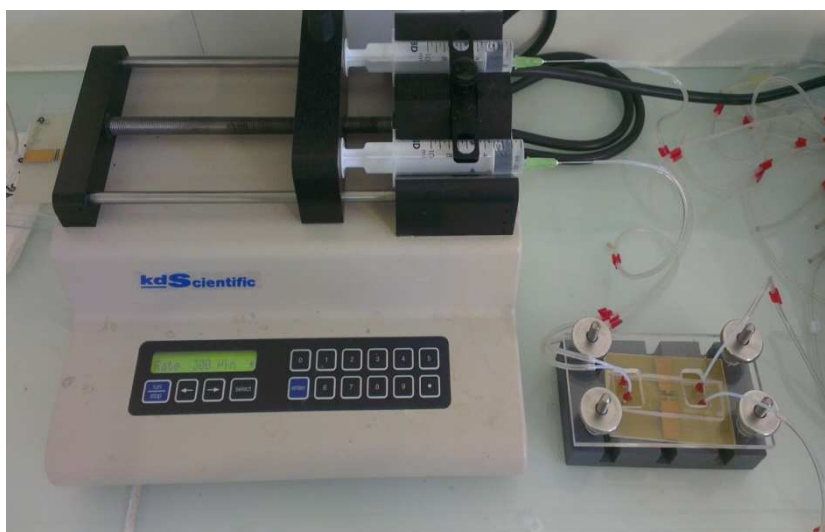
Figure II.4: Photographie de l'ensemble du dispositif comprenant la cellule microfluidique, le pousse seringue et les seringues.
