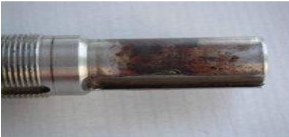
Figure 2.17 : Exemple d'usure par corrosion.
