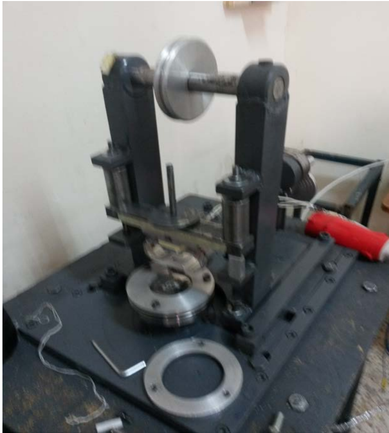
Figure 4.2 : Tribomètre de type pion/disque (Laboratoire de Mécanique structures et Energétique de l'Université Mouloud Mammeri de Tizi-Ouzou).
