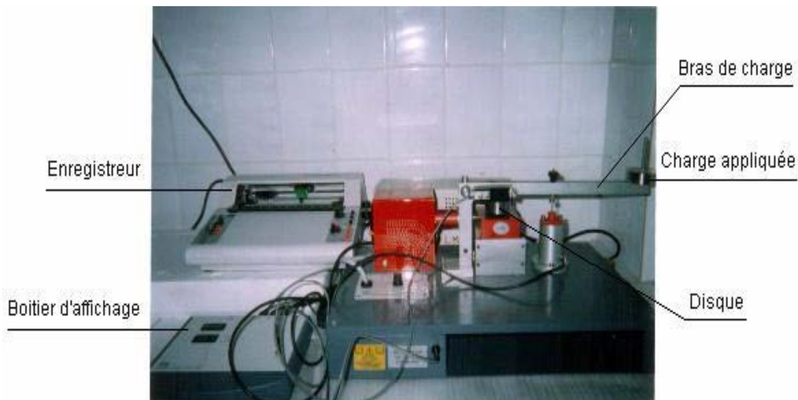
Figure 4.1 : Tribomètre de type pion/disque (Laboratoire de Mécanique de l'Université de Constantine)
