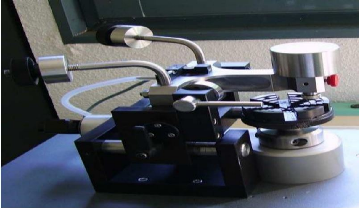
Figure 2.9 : Exemple d'un tribomètre (bille sur disque).
