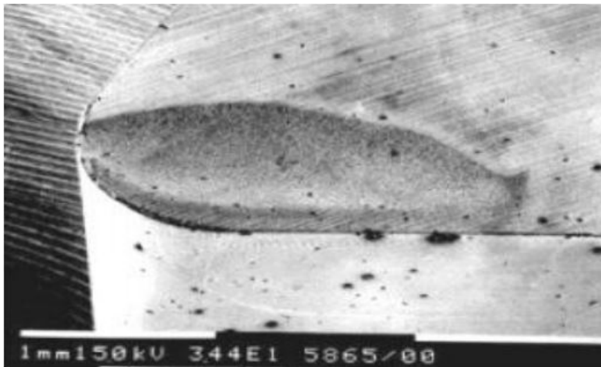
Figure 2.16 : Cratère formé par l'usure par diffusion sur une plaquette de carbure après 20 secondes d'usinage d'un acier AISI 1020. [5]
