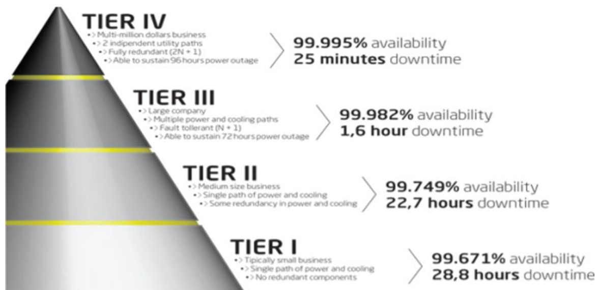
Figure 13 : Les différents tiers du Datacenter
