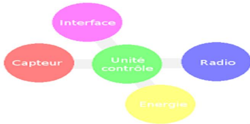
Figure 7 : Composants de l'IoT
