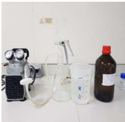
Figure 23 : filtration sous -vide
