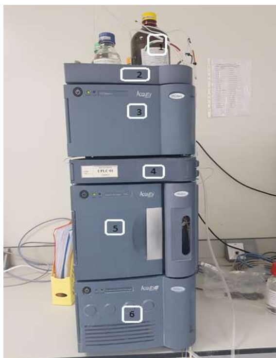
Figure 7 : Image représentant un UPLC et le rôle de chaque module
