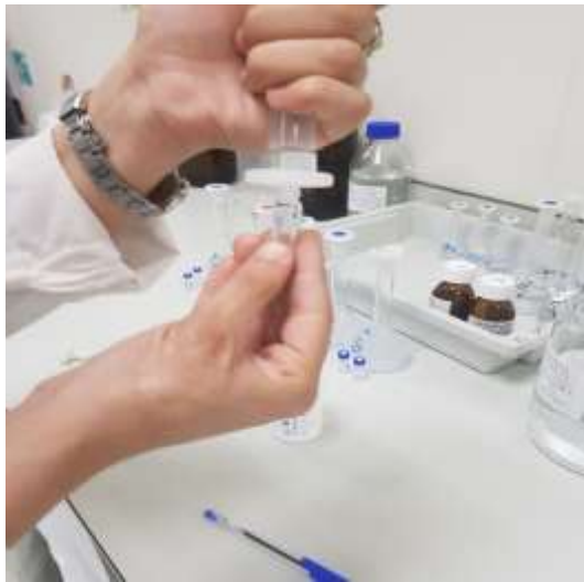
Figure 27 : remplissage des viales à l'aide d'un Filtre PTFE 0,45 \mu\text{m} .
