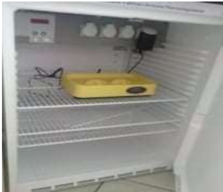
Figure n° 15 : Enceinte DBO- mètre
