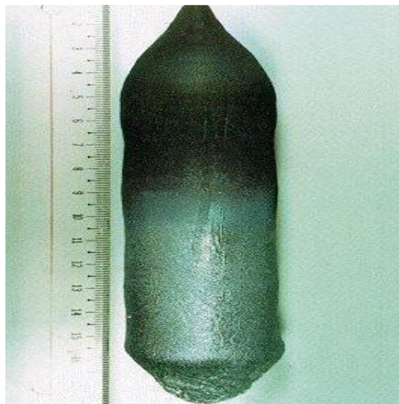
Figure (I.8) : Cristal de GaAs obtenu grâce à la méthode Czochralski[9].
