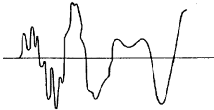
Fig. I-3 : Enclenchement d'une ligne à vide
