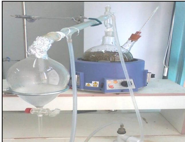
Figure 5 - Montage d'hydrodistillation utilisé
