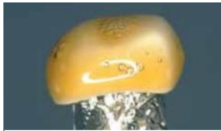
Figure 32 Cuisson de l'infiltration du verre sur une tige en platine
