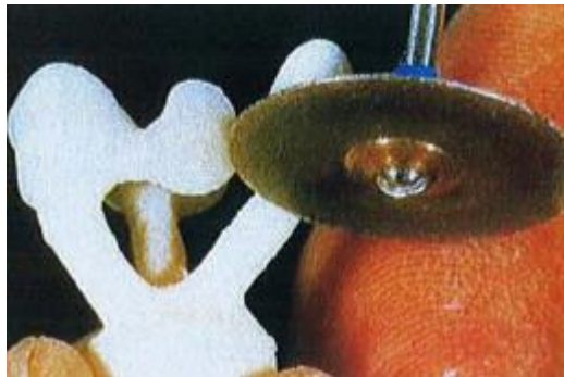
Figure 24 Séparation des tiges de coulées
