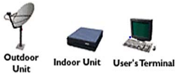
Figure II-13 : composants d'un site VSAT distant [9]
