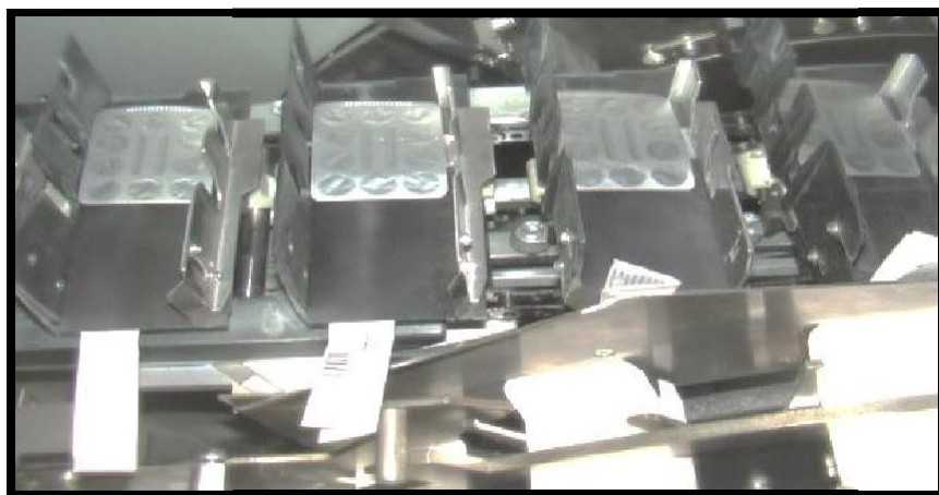
Figure 18. L'opération de conditionnement secondaire.
