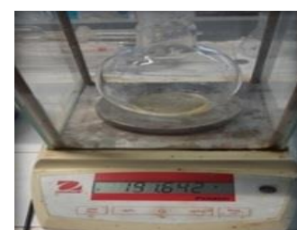
4. Pesage après évaporation
