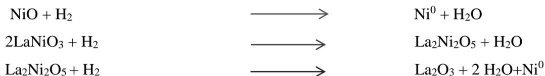
D'après ces résultats, on note bien que l'utilisation du support a fait augmenter les températures de réduction de la pérovskite supportée. Alors que pour la pérovskite massique, les températures de réduction ne dépassent pas 600°C. [62]. Même conclusion a été faite par J. P. Dacquin et col [6] sur l'effet de la SBA sur les températures de réduction de LaNiO<sub>2</sub>/SBA
