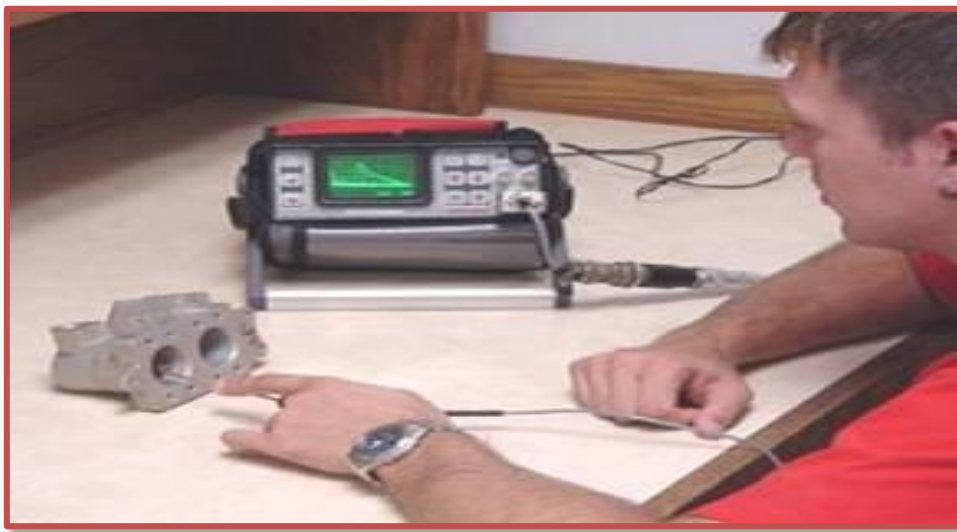
Figure I.6 : Contrôle par courant de Foucault
