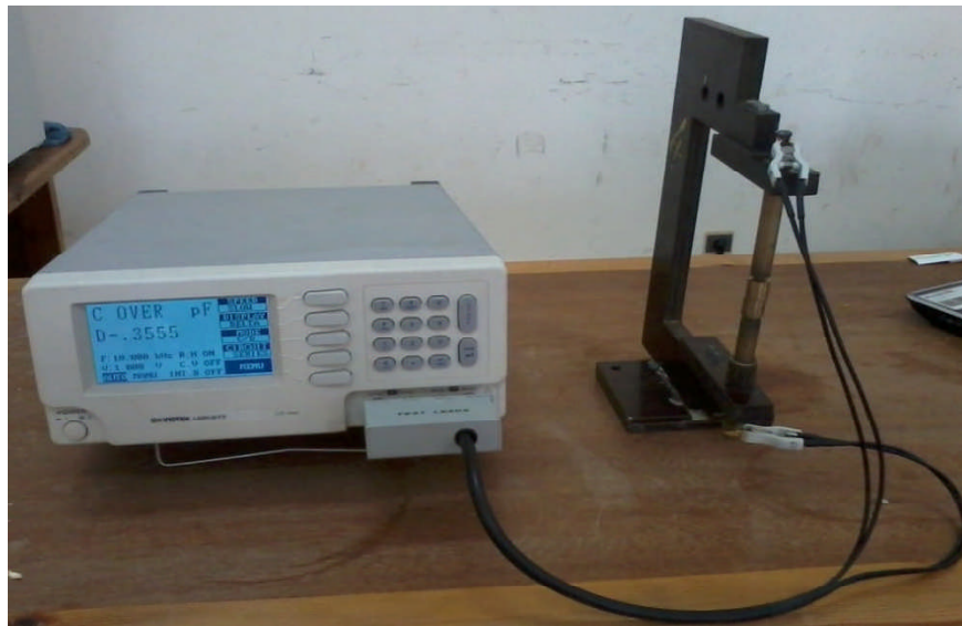
Figure III.5 : Montage expérimental utilisé pour la caractérisation diélectrique
