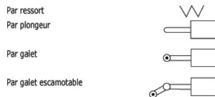
FIGURE 1.15 – Symboles des commandes mécaniques d'un distributeur.
