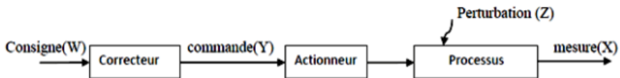
FIGURE 2.4 – Schéma de régulation en boucle ouverte [20].
