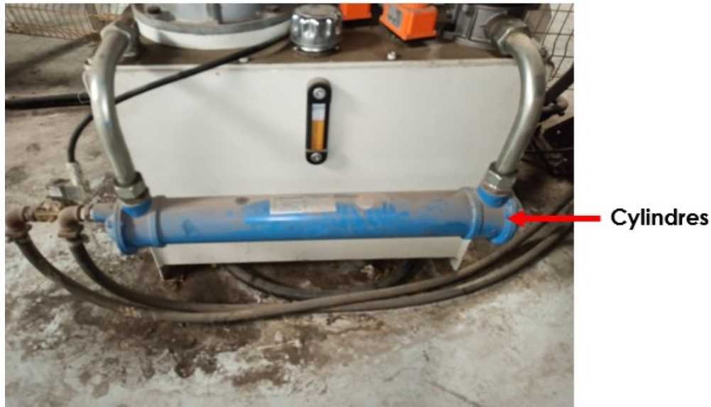
FIGURE 2.12 – Système de refroidissement.
