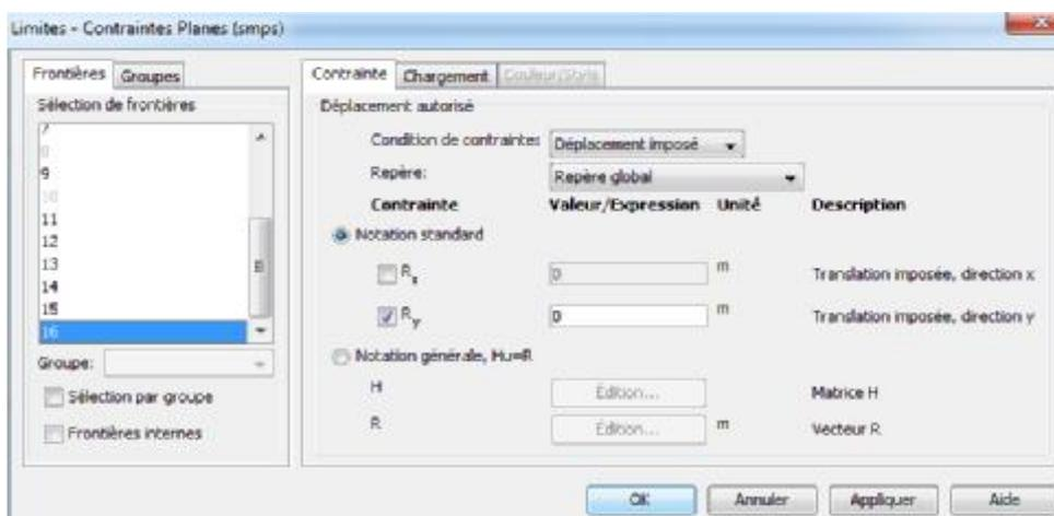
Figure (IV-14) : Condition de contrainte sur la structure du panneau solaire PV étudié
