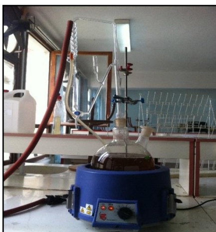
Figure 2.3 : Hydrodistillation de l'EH par un appareil de type : Clevenger.
