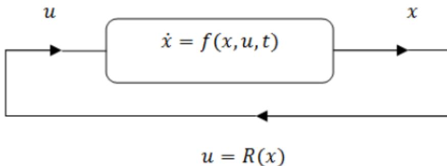
FIGURE 2.2 – Système en boucle fermée
