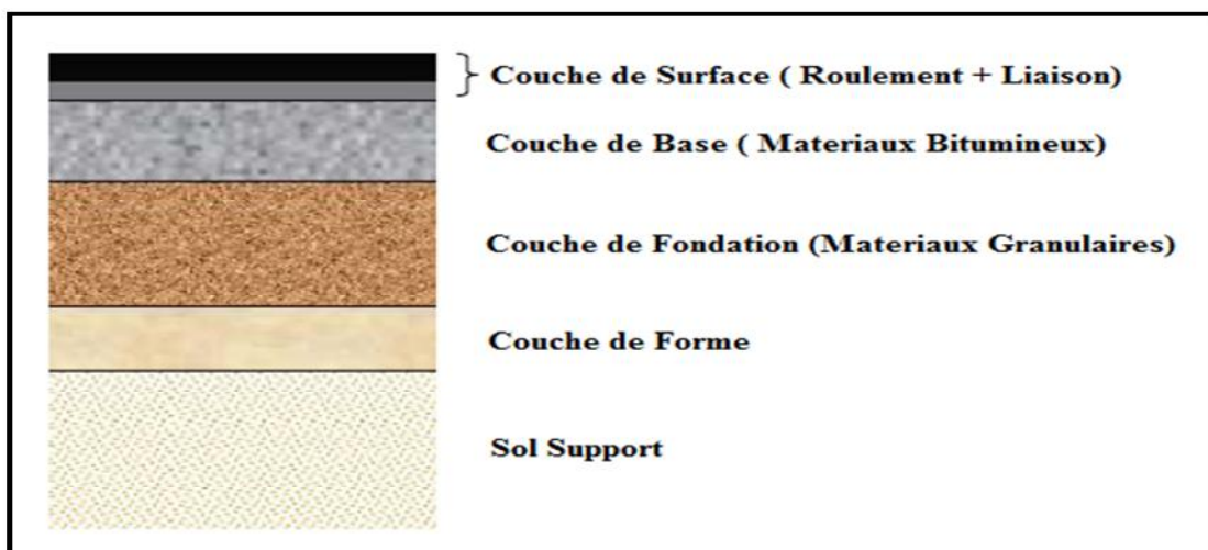
Figure N° V.1 : Illustration d'une structure de chaussée souple.
