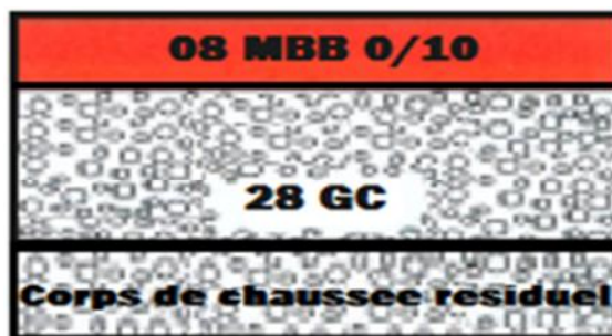
Figure N° VI.3 : Illustration du renforcement des accotements.
