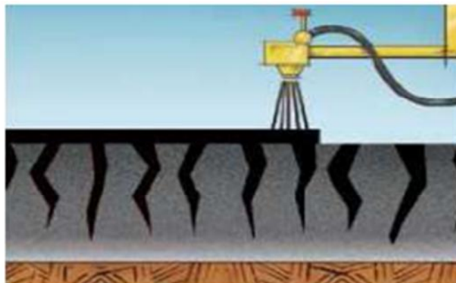
Figure N° VI.8 : Mise en œuvre de la couche d'accrochage.
