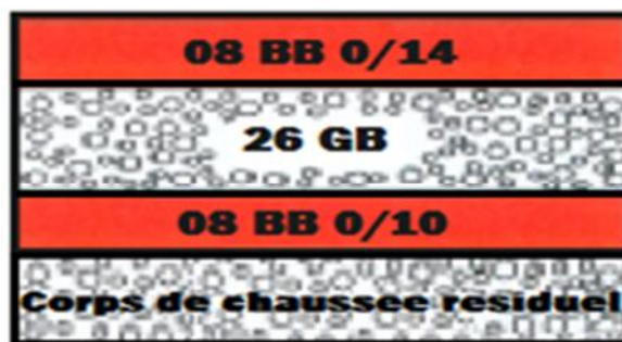
Figure N° VI.5 : Illustration du renforcement du Parking.
