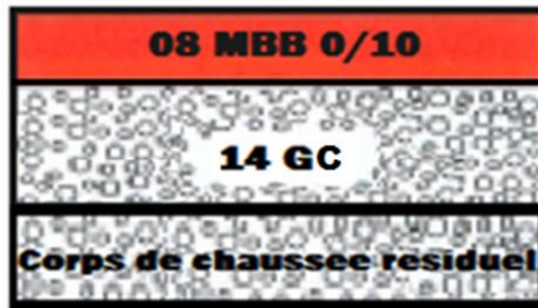
Figure N° VI.4 : Illustration du renforcement des SWY (POR).
