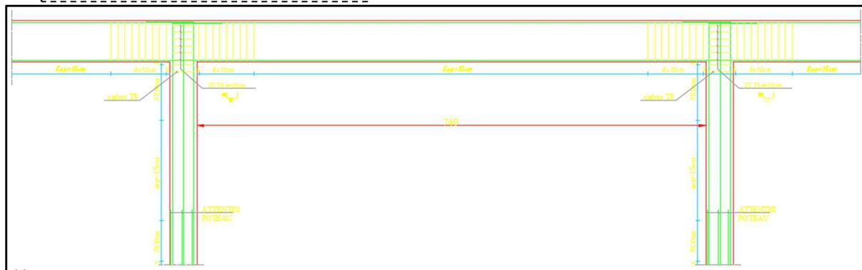
Figure 197 : jonction poteau poutre en béton armé
