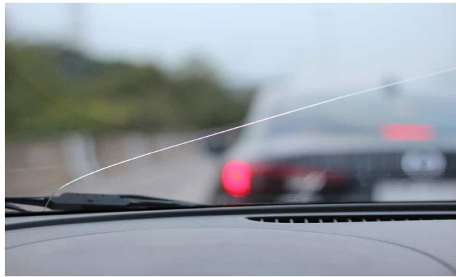
FIGURE 1.12 – Défaut de rayure sur un par brise d'un véhicule
