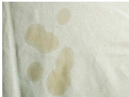
FIGURE 1.11 – Défauts de tâches sur un textile
