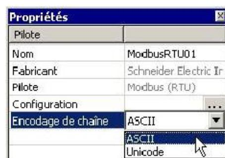
Le code de caractère sélectionné dans la propriété Encodage de chaîne est utilisé lors de l'écriture de données dans l'équipement à partir du clavier et lors de l'affichage de données à partir d'adresses de périphérique.
