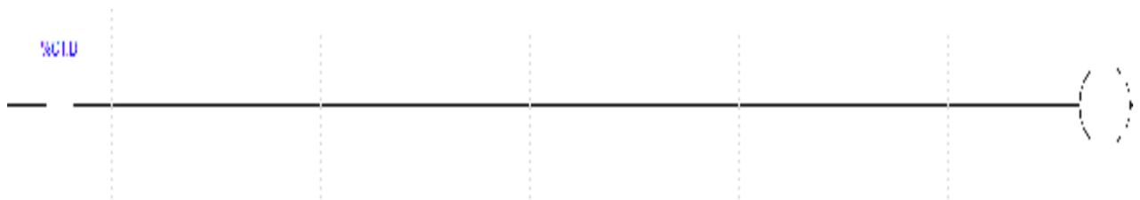
%X0.6 → %X0.7 : fermeture de la vanne de remplissage tank M1
