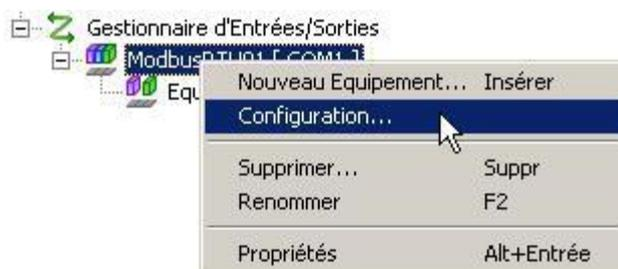
2. Définissez les paramètres de communication dans la boîte de dialogue Configuration du pilote. Selon le pilote sélectionné, différents champs apparaissent
