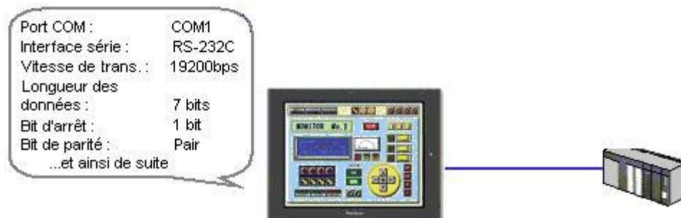
Figure C.2: exemple d'une configuration des paramètres de communication.
