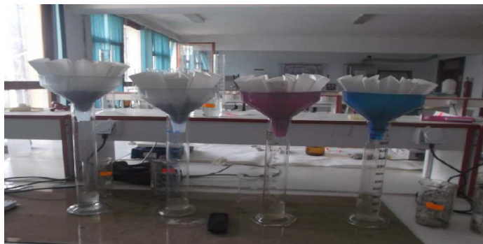
Photo V.3 : Déshydratation des boues conditionnées
