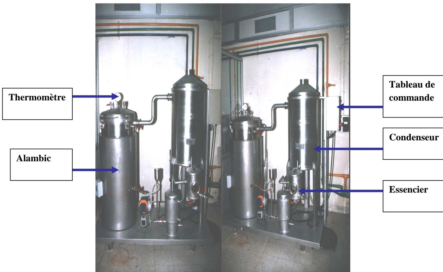
**Figure 14 :** Extracteur pilote (Centre de recherche et de développement de Saidal, Alger, photo originale, 2006).
