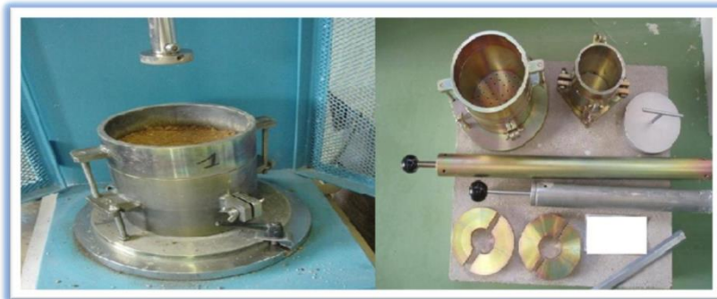
Figure III.6 : Appareillage des essais PROCTOR normal et modifié.
