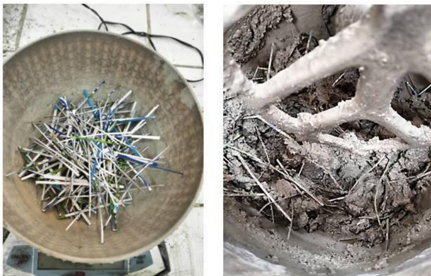
Figure. II.16 : Introduction des fibres dans le mélange
