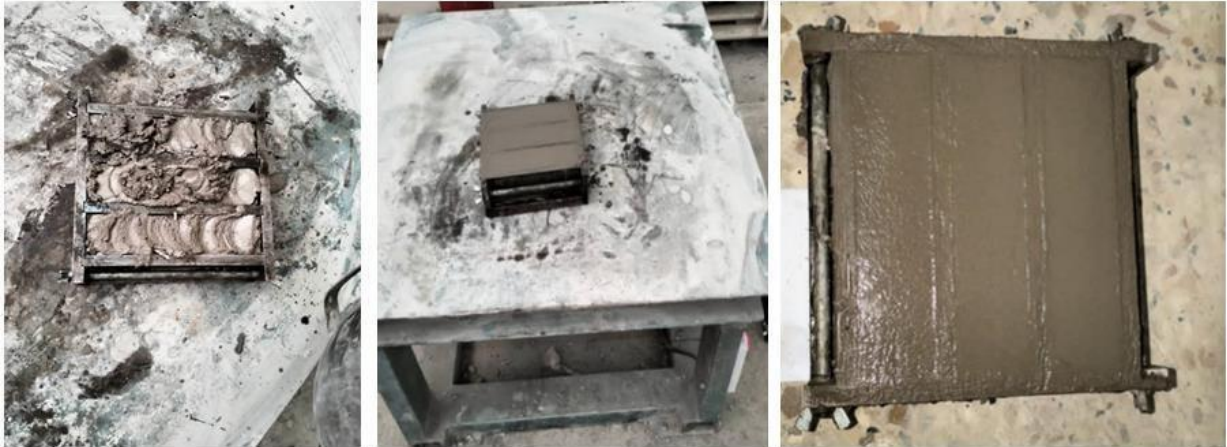
Figure. II.17 : Coffrage des spécimens dans les moules
