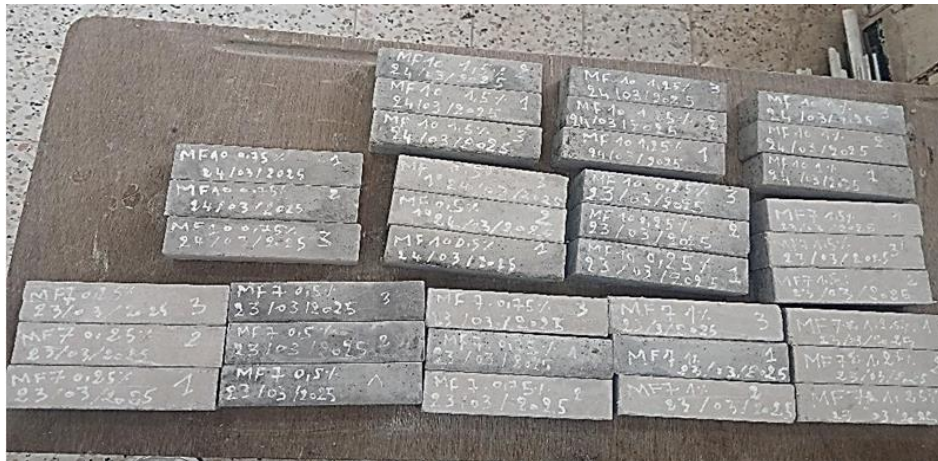
Figure III.18: Etat des éprouvettes avant écrasement.
