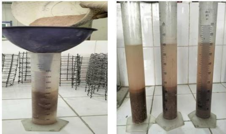
Figure. II.4 : Essai de la masse volumique absolue
