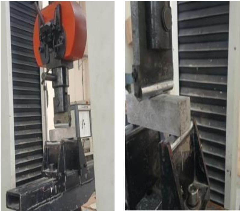
Figure. II.19 :Essai de traction par flexion
