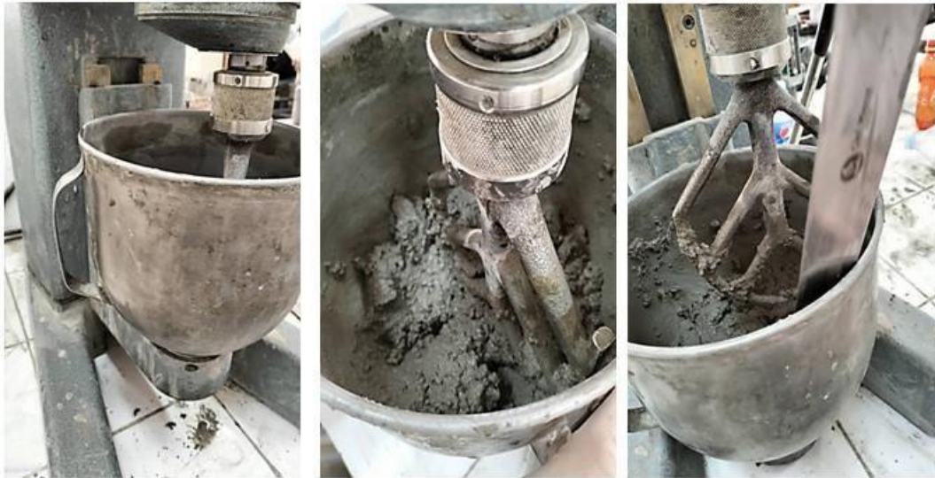
Figure. II.15 : Elaboration des mortiers.
