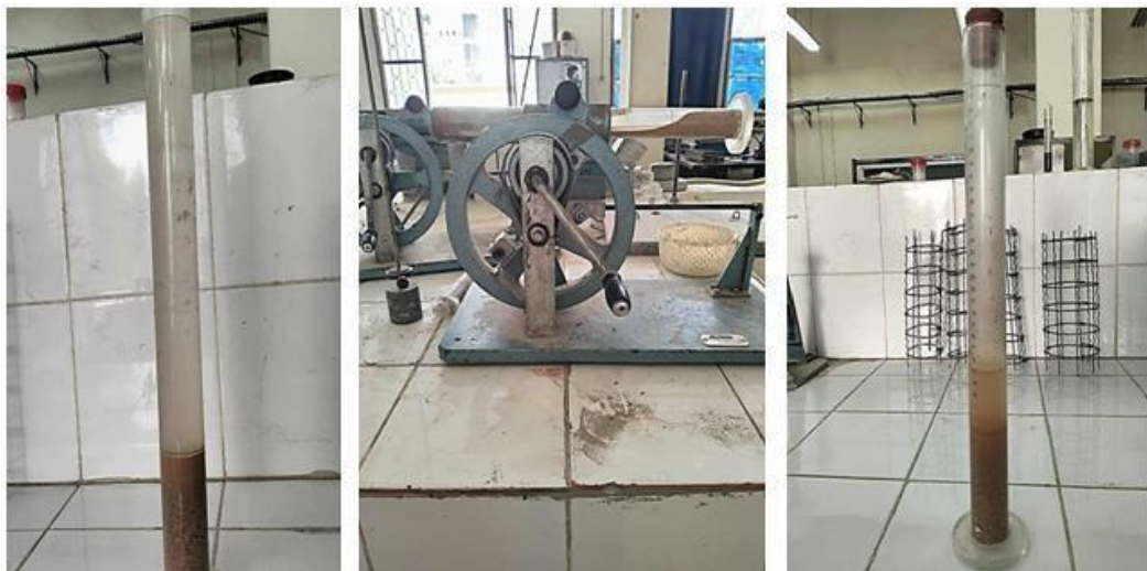
Figure. II.5 : Essai d'équivalent de sable
