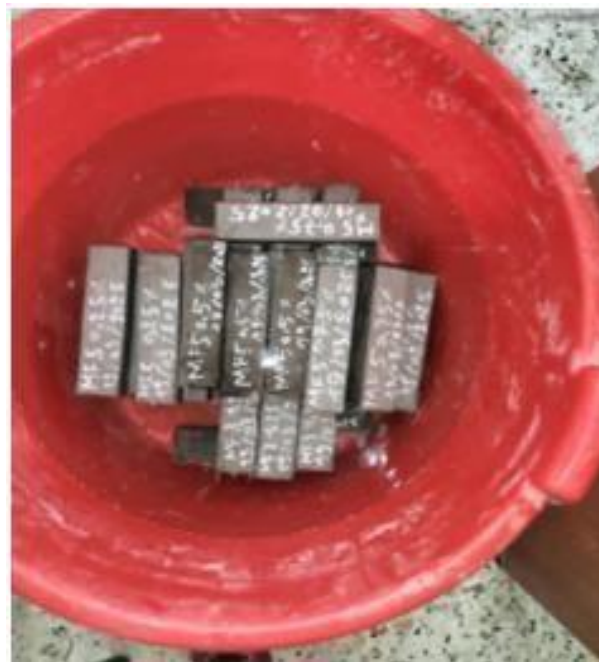
Figure. II.18 : Conservation des éprouvettes pendant 28 jours dans l'eau.
