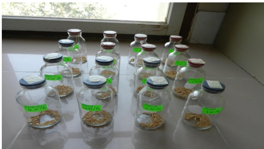
Figure 9. Dispositif expérimental du test par inhalation de l'huile essentielle de bigarade à l'égard des adultes de R. dominica (Originale, 2020).
