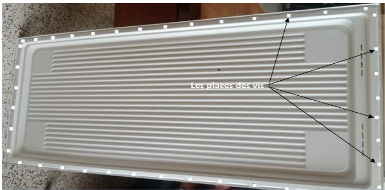
Figure IV.18 : la contre porte congélateur 220F l'ancienne.
