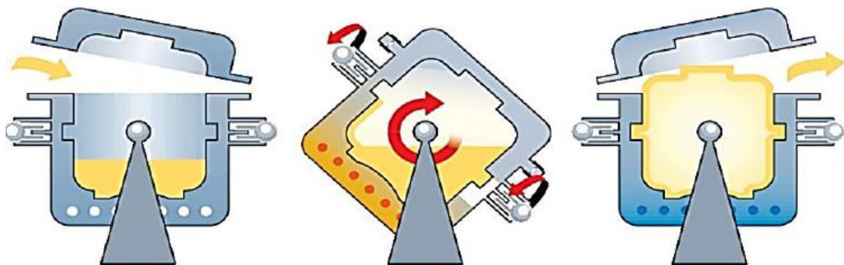
Figure III.4 : Les différentes phases d'obtention d'une pièce par roto moulage
