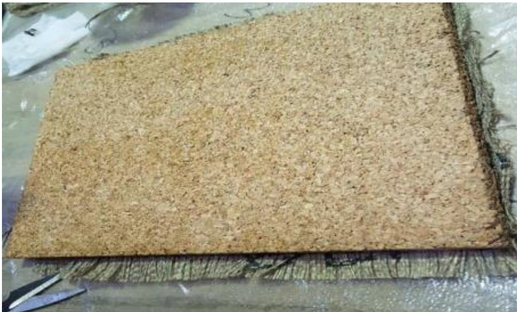
Figure II-4 Assemblage de peau (fibre de jute) + l'âme (le liège)
