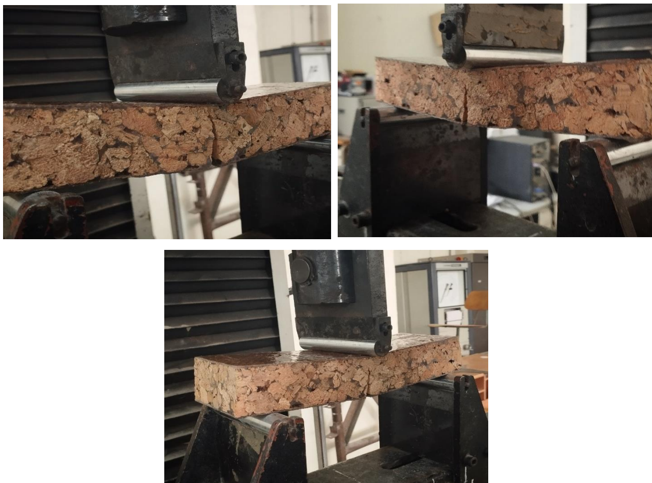
Figure III-5 : Eprouvettes sollicité en flexion
