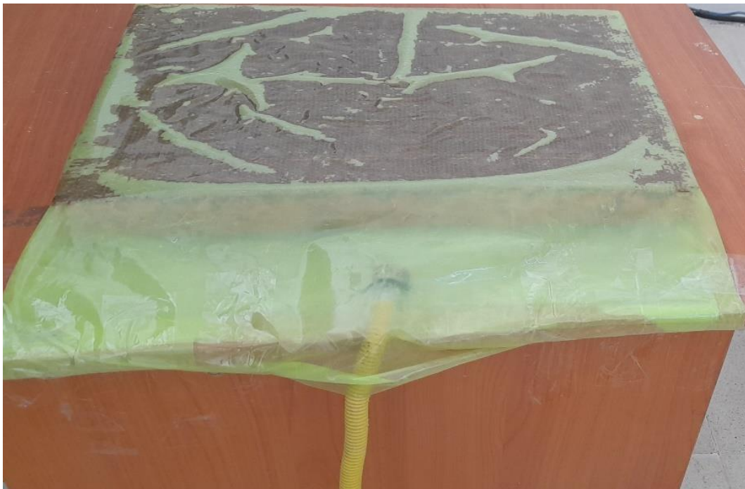
Figure II-6: application de l'opération sous vide sur le composite
