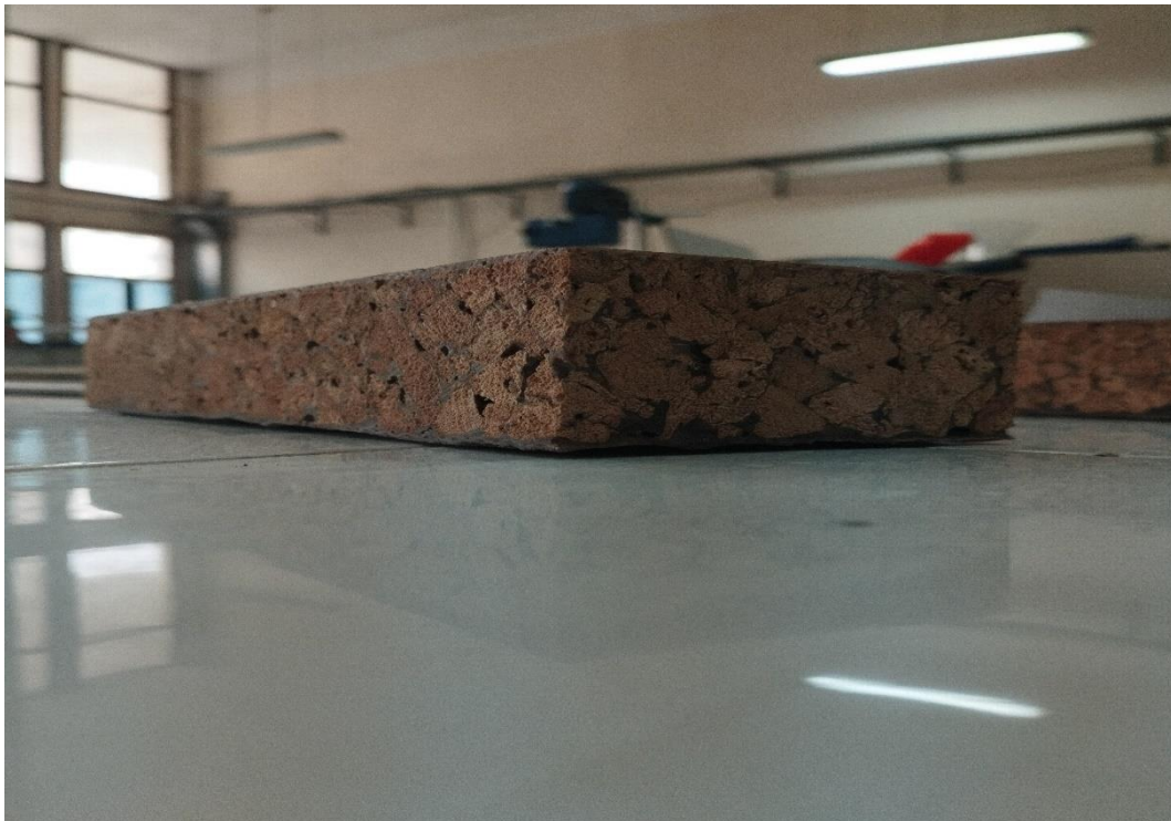
Figure II-11: sandwich liège, jute, résine époxy
