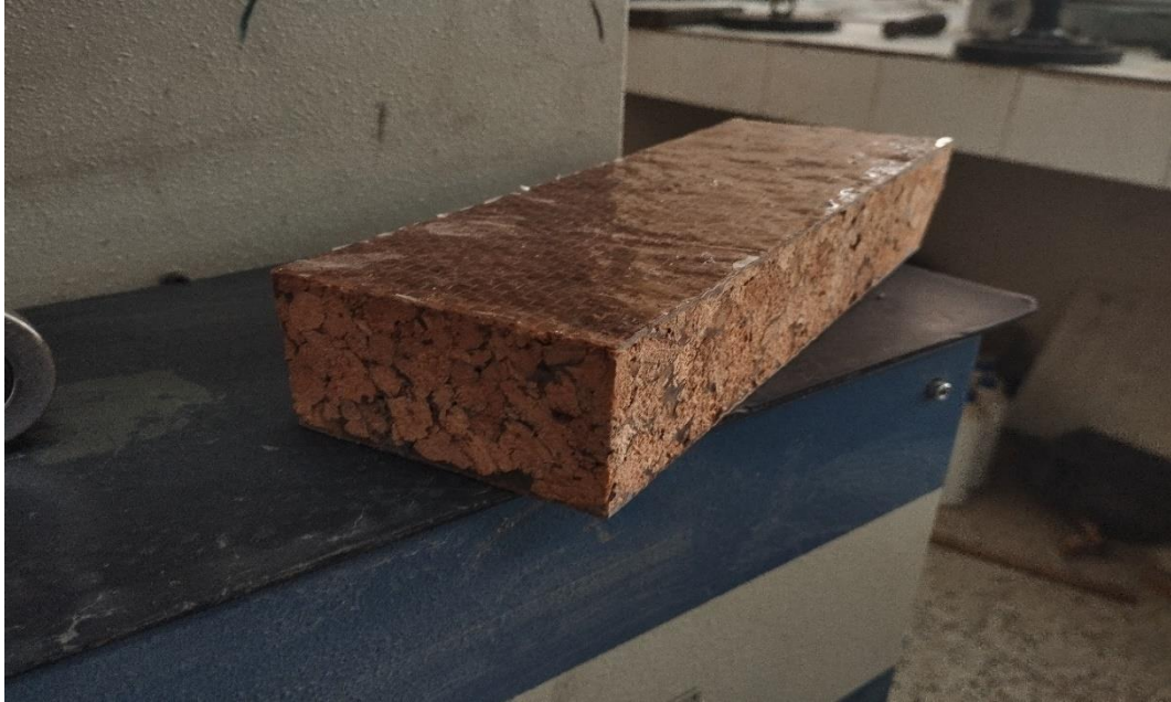
Figure II-12: sandwich liège jute résine époxy
