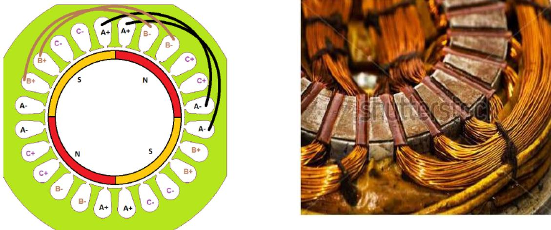
Figure. I.2. Exemple d'un bobinage croisé réparti [21].
