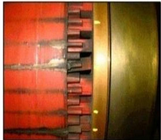
Figure.1.17. Défaut de cassure de barres rotoriques.
