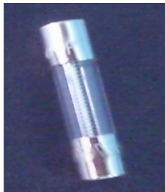
Figure I-18 : Présentation des fusibles
