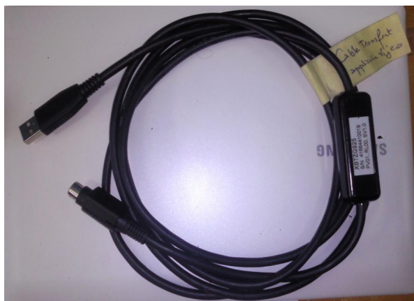
FigureIV-5 : présentation câble pour transfert l'application de PC vers XBTGT1100
