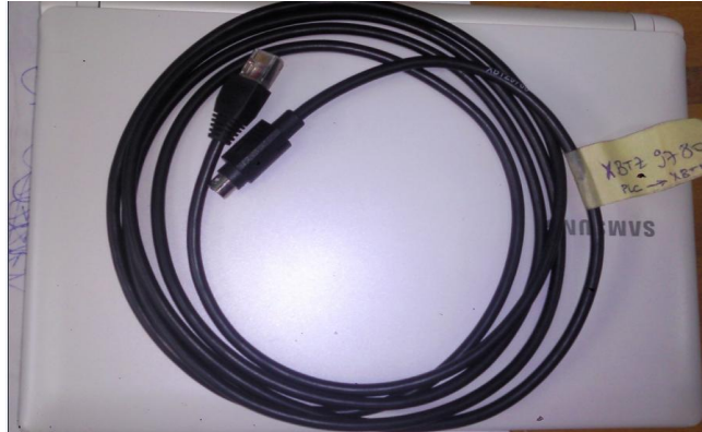
Figure IV-6: Présentation câble pour transfert l'application de l'AP versXBTGT1100
