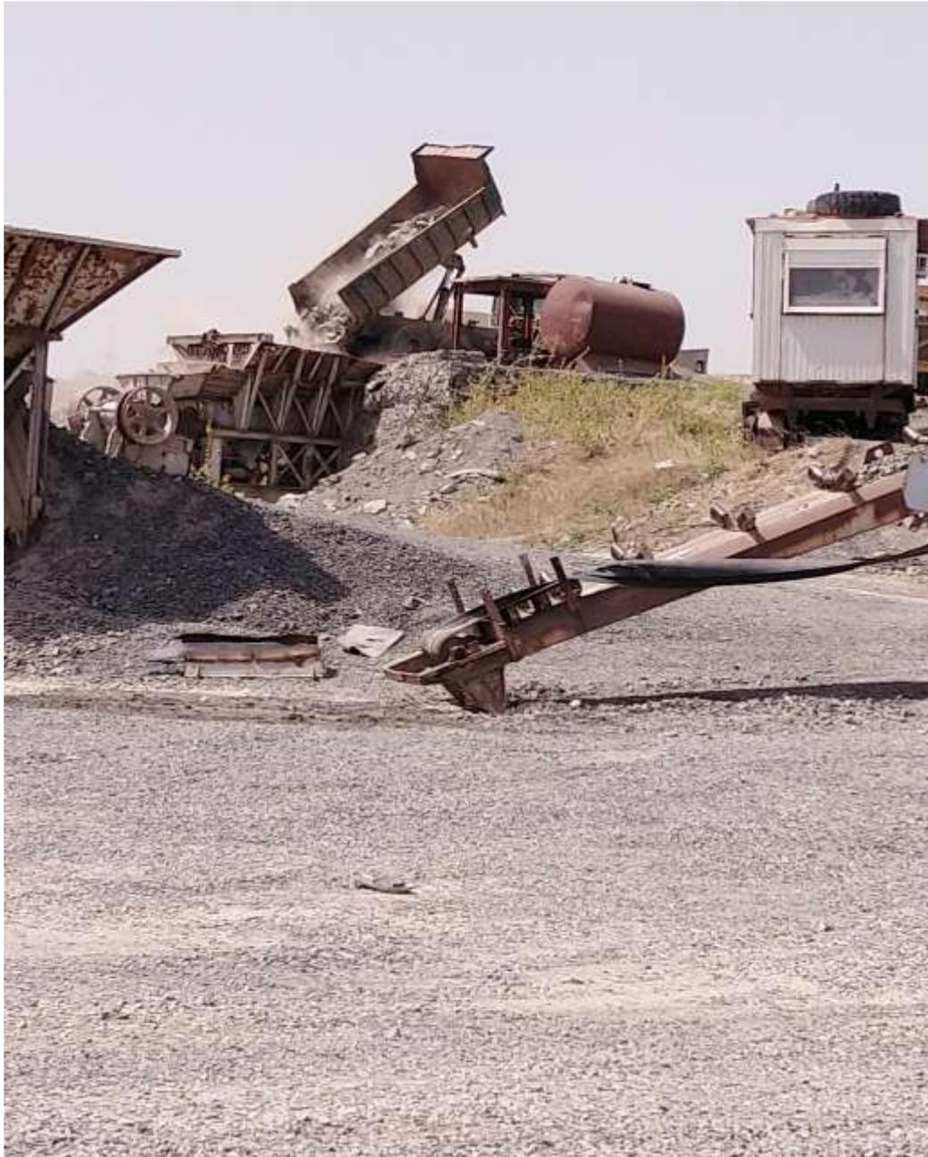
**Fig.V.5 : une citerne d'eau au niveau de la station de concassage pour l'arrosage**
