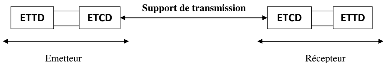
Figure I.1 : éléments d'une liaison de données
