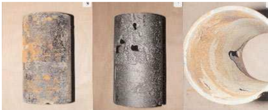
Figure (V.1) : Corrosion des conduites en font
