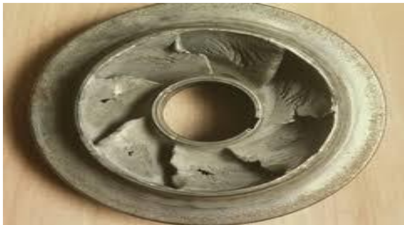
Figure (VI.4) : photo illustrant le phénomène de cavitation sur des aubes d'une pompe centrifuge
