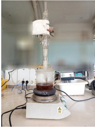
Annexe 1 : Dispositif montage à reflux
