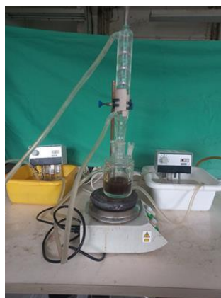
Annexe 5: dispositif de l'hydrolyse
