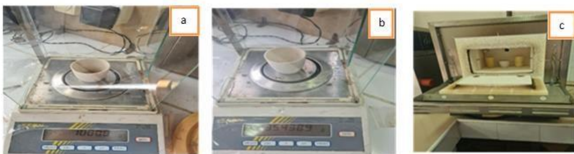
Figure 3. a. Pesée de poudre d'armoise blanche, b. Pesée de verre en porcelaine vide, c. Incinération des trois creusées dans le four à moufle.
