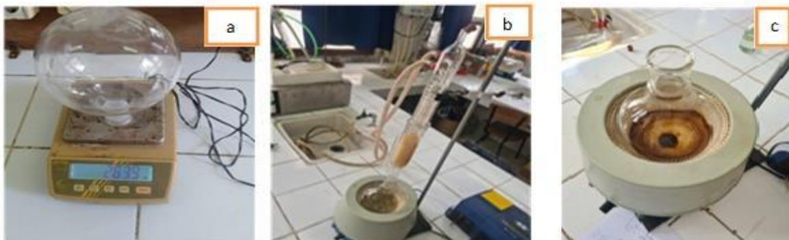
Figure 4. a. Pesée du ballon vide, b. Méthode d'extraction par soxhlet, c. Ballon après évaporation
