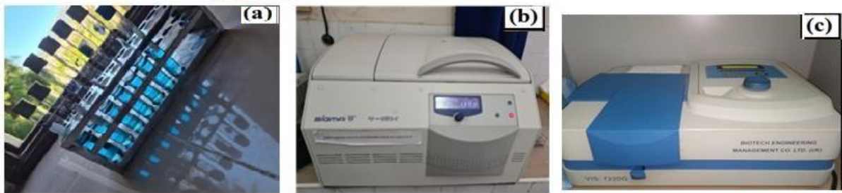
Figure 8. (a). Dosage de l'activité antioxydante, (b). Centrifugation, (c). Lecture au spectrophotomètre
