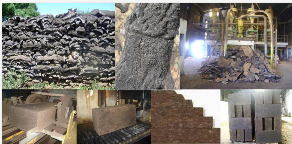
Figure N °04 : Le liège flambé et la fabrication des panneaux d'isolation à JLE de Jijel.
