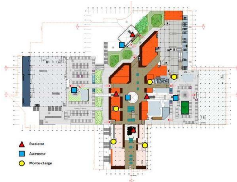
Figure 56 : Liaisons mécaniques intérieures permettant l'accès à la terrasse. (Source : Observations du Maître d'Ouvrage suite au PV de synthèse de l'enquête publique portant sur la demande de permis de construire n° PC 069 383 16 00352 - Août 2017).
