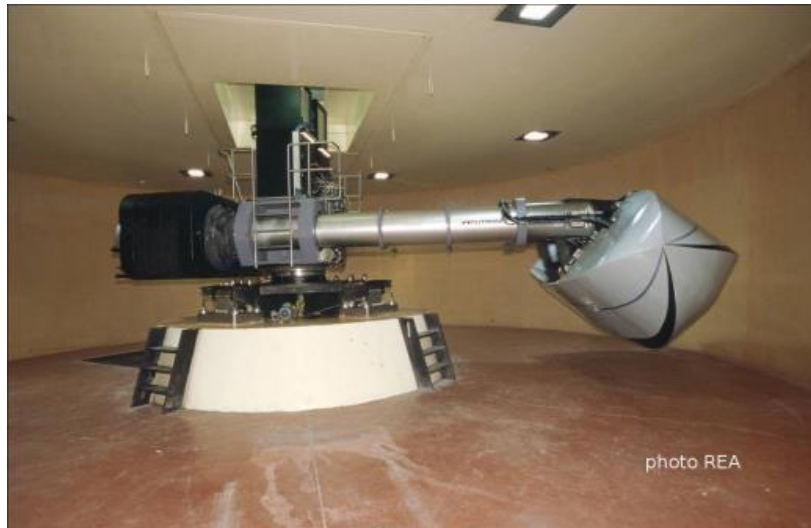
Figure 1.6. Centrifugeuse géotechnique (IFSTTAR – Nantes)(Association Française du génie Parasismique, 2014)
