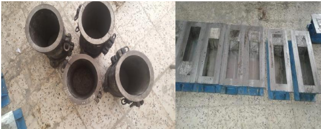
Fig.II.7. Moules normalisés utilisés.
