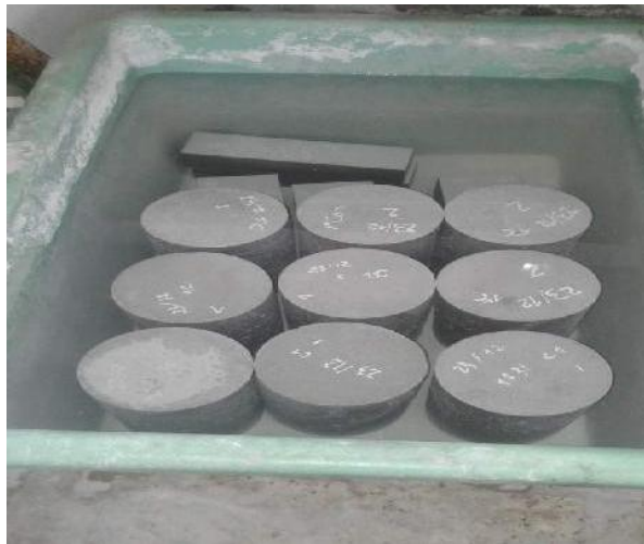
Fig.II.9. Cure d'hydratation des bétons.
