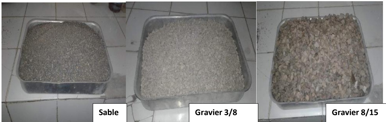
Fig.II.2. Granulats utilisés dans la confection des bétons.
