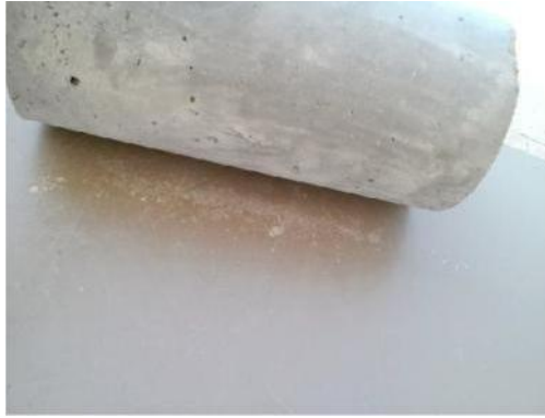
Fig. II.10. Traitement des surfaces des spécimens.
