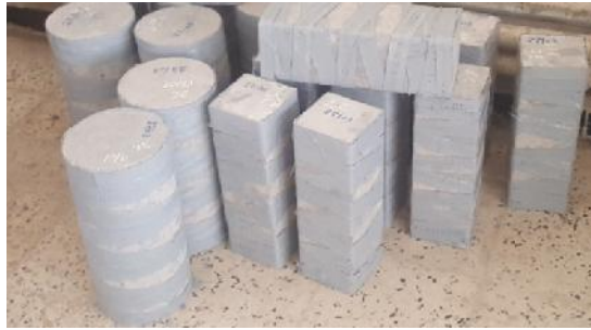
Fig. II.14. Séchage des spécimens confinés.
