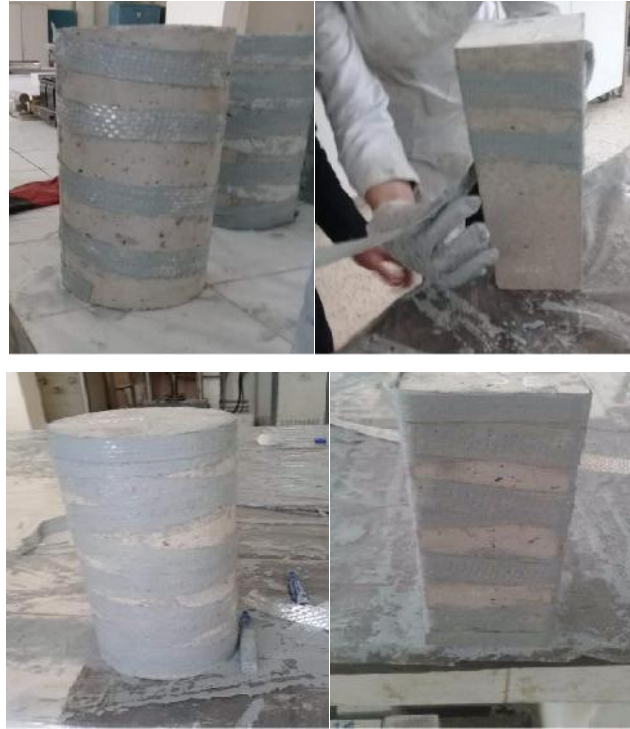
Fig. II.12. Mise en place du PRFV.
