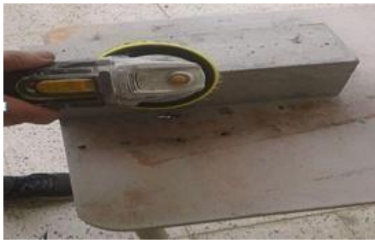
Fig. II.11. Traitement des arêtes des spécimens prismatiques.
